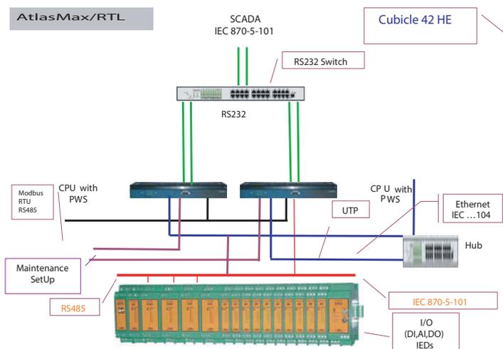
piko Atlas® je minijaturni modularni RTU za akviziciju podataka i kontrolu, sa mogućnošću implementacije PLC algoritma. Sastoji se od jednog master CPU modula i I/O slave modula, maksimum 8 modula od svakog tipa. Svi moduli su međusobno povezani preko I2C magistrale. Trenutno postoje sledeći tipovi I/O slave modula:
