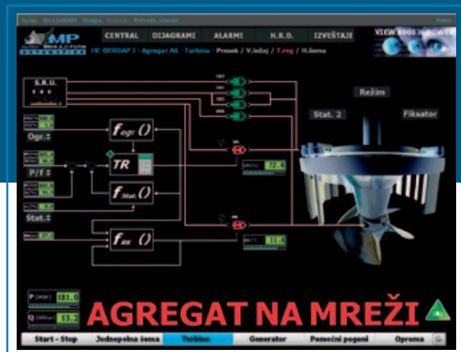
Sistem upravljanja je uključio u jedinstveni upravljačko-informacioni sistem i sve druge podsisteme agregata, sistem turbinske regulacije, pobude, vibromonitoring, monitoring parcijalnih praznjenja. Na taj način je agregat broj 6, snage 200MW, opremljen po najsavremenijim svetskim standardima i predat na eksploataciju u vremenu kada je svaki kilovat dragocen zbog manjka energije u okruženju.
