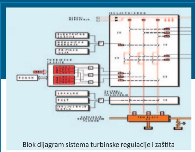
Za potrebe projekta morao je biti napravljen hardverski model turbine, napravljenom na „National Instruments“ razvojnom okruženju. Nakon dugih procesa simulacije, gde su provereni svi mogući režimi rada turbine, i reagovanja hidrauličke i elektronskog dela regulatora na različite događaje, turboagregat 210MW je pušten u rad sa rekonstruisanim sistemom hidrauličkog i elektronskog dela turbinske regulacije.
