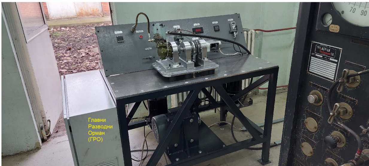
Слика 5- Изглед реализованог испитног стола за испитивање компресорских мотора
