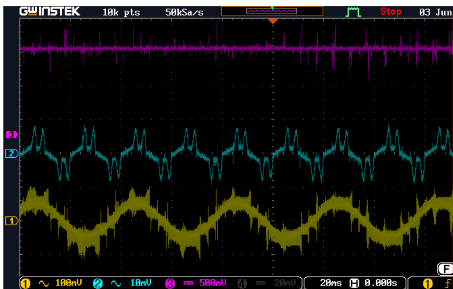
Слика 11-Осцилоскопски снимци у режиму задате брзине 1530 об/мин; CH1- струја погонског мотора (10А/див) , CH2- струја мреже (10А/див), CH3- брзина обртања излазног вратила 650 об/мин /див, временска база 20ms/див
