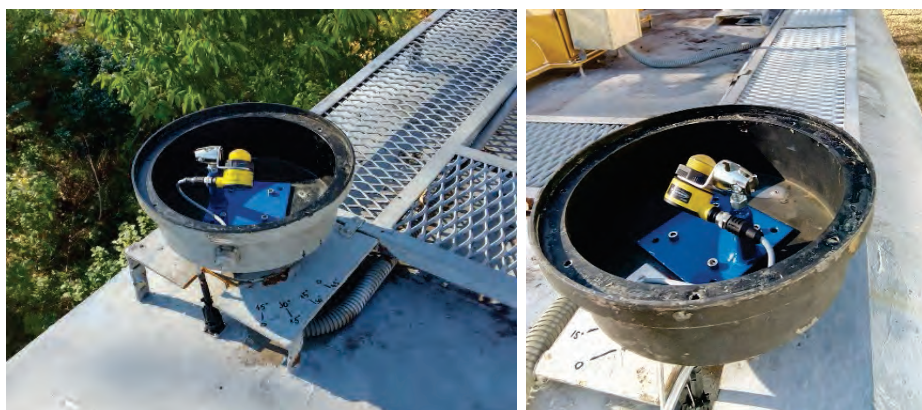
Сл. 9 - Радарски сензори за регистровање тачки вешања лево и десно
