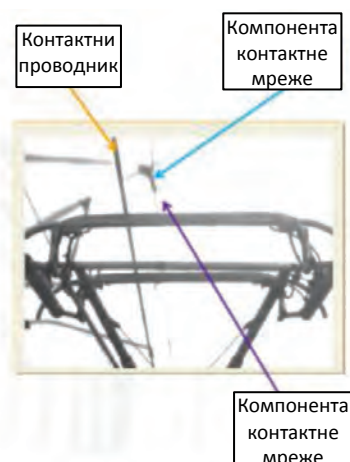
Сл. 4 – Принцип мерења дигиталном обрадом слике
