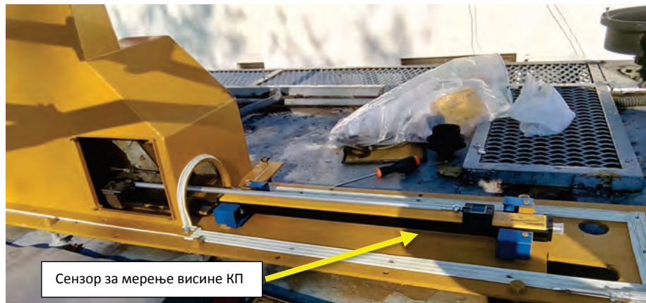
Сл. 8 - Инсталација сензора за мерење висине КП
