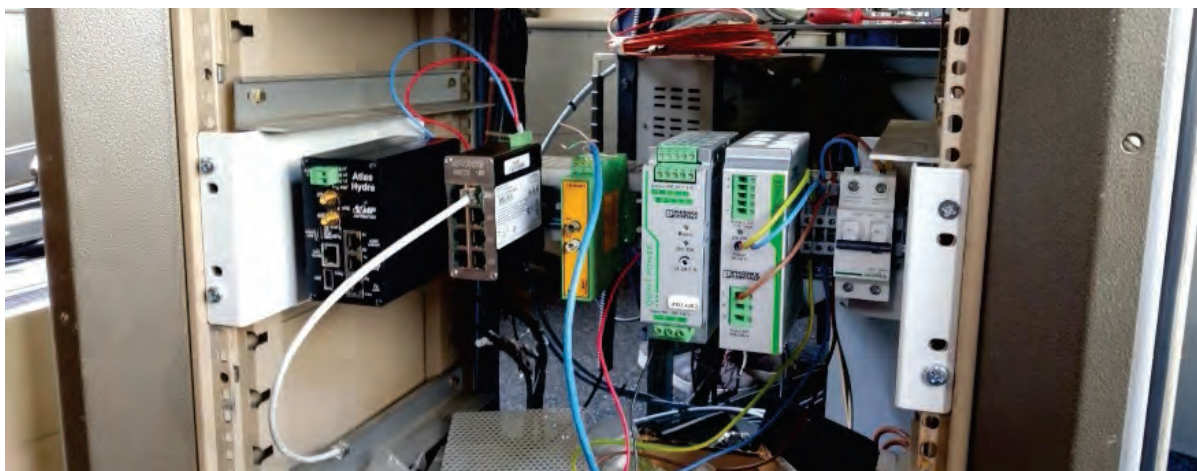
Сл. 13 - Инсталација мерно аквизиционог система у мерним колима
