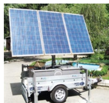
Slika 1: Mobilni robotizovani solarni elektrogenerator: (a) u sklopljenom stanju, (b) u položaju spremnom za transport (c) u radnom položaju
