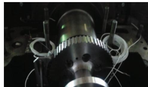
*Slika 2 - Sklop za merenje brzine turbine*
