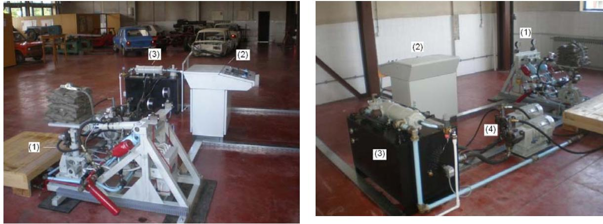
Sl.19. Izgled realizovanoglaboratorijskog postrojenja na Mašinskom Fakultetu u Kragujevcu (Laboratorijska za ispitivanjem motornih vozila ;(1)-hidraulička platforma , (2)-Upravljački pult, (3)-Hidraulički uljni tank, (4)-Elektromotori M1 i M2 pumpnog agregata
