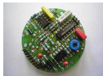
Sl.24. Izgled elektronskog pojačavača servo ventila SV1,SV2
