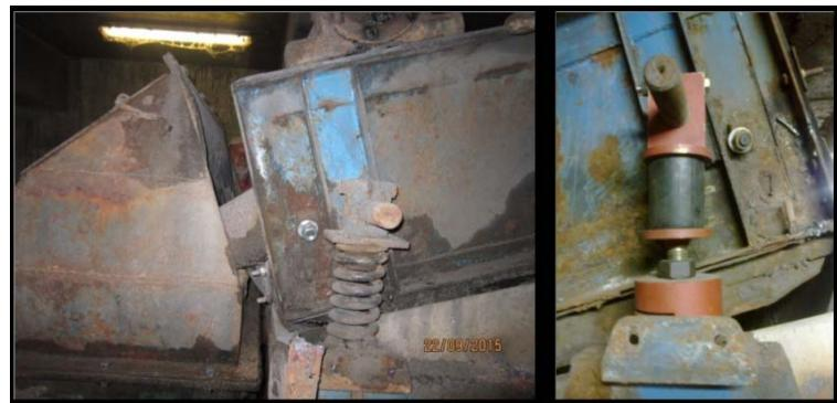
Slika 13: Uporedni prikaz elastičnih oslanjajućih elemenata; staro vibraciono sito (levo), novo vibraciono sito (desno)
