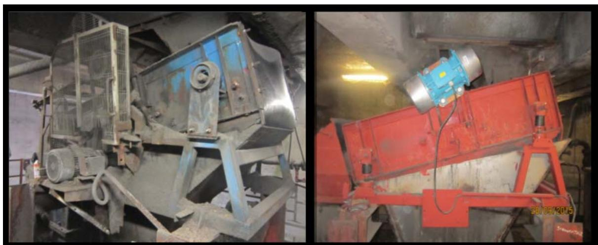
Slika 13: Uporedni prikaz vibracionih sita; staro vibraciono sito (levo), novo vibraciono sito (desno)
