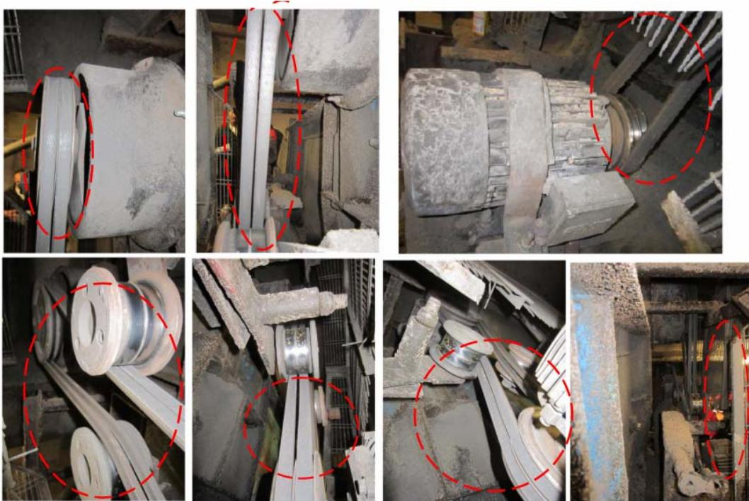
Slika 1: Prikaz problematičnih mesta u kaišnom prenosu (pučanje kaiševa) postojećeg pogona vibracionih sita
