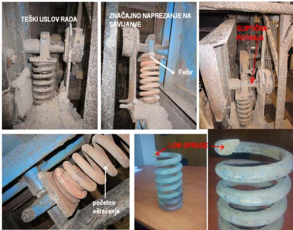
Slika 2: Problemi sa deformacijom i pučanjem nosećih opruga postojećih vibracionih sita
