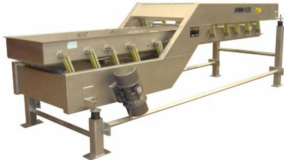
Слика 1. Вибрационни дозатор производа „MEYER INDUSTRIES”, са електромеханичком побудом
