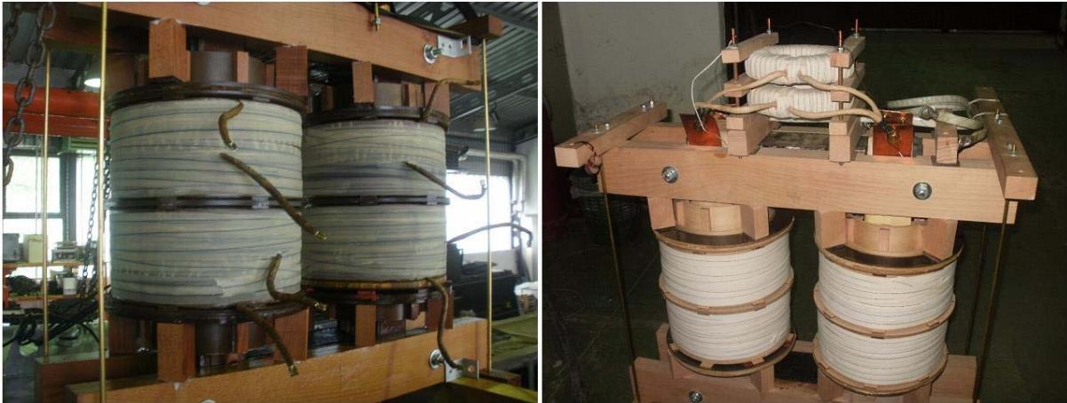
Slika 9: VNVF trafo sa integrisanom prigušnicom u primaru; VNVF trafo pre montaže u transformatorski sud sa uljem, (b) VNVF transformator sa prigušnicom  $L_s$  koja je montirana na gornjoj strani.
