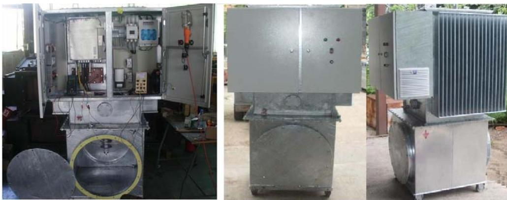
Slika 11: Unutrašnjost VNPF napajanja AR100/1000 (slika levo) i izgled napojne jedinice sa distribuiranom multi-rezonantnom topologijom (slika desno), a pre isporuke u realne eksploracione uslove na termoelektrani.
