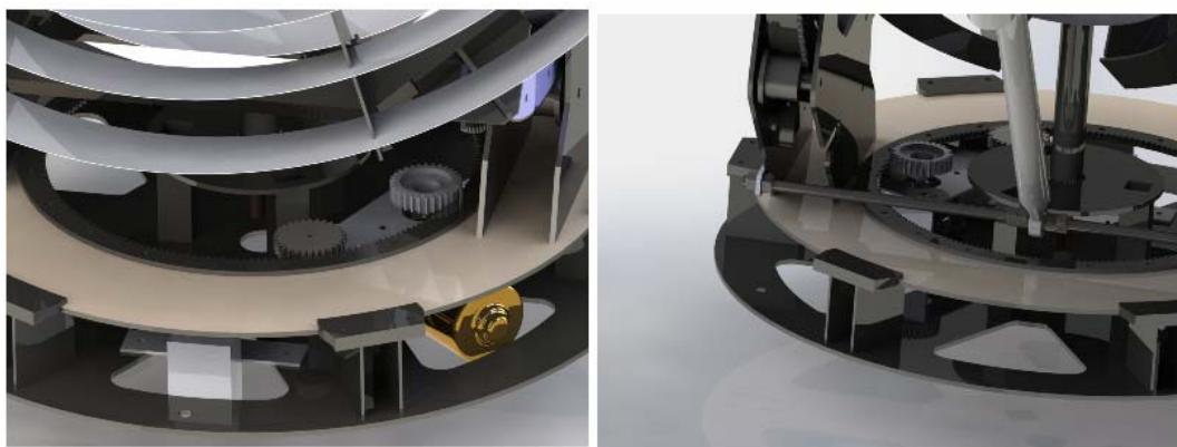
Slika 9 : Mehanizam za pogon po azimutu sa enkoderom
