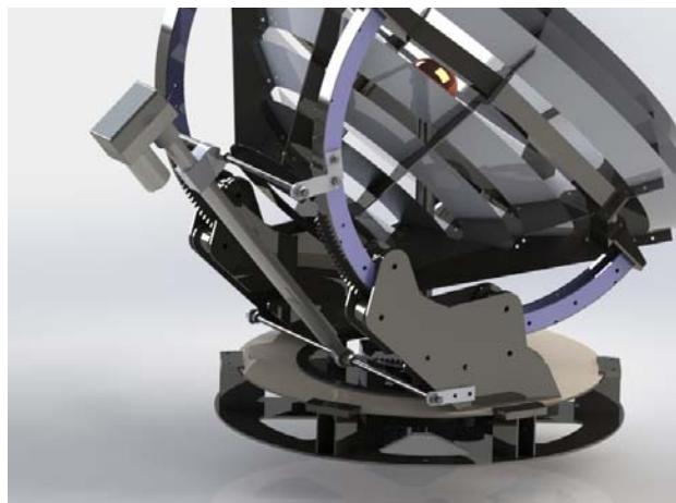
Slika 8 : Mehanizam pogona po elevaciji sa enkoderom
