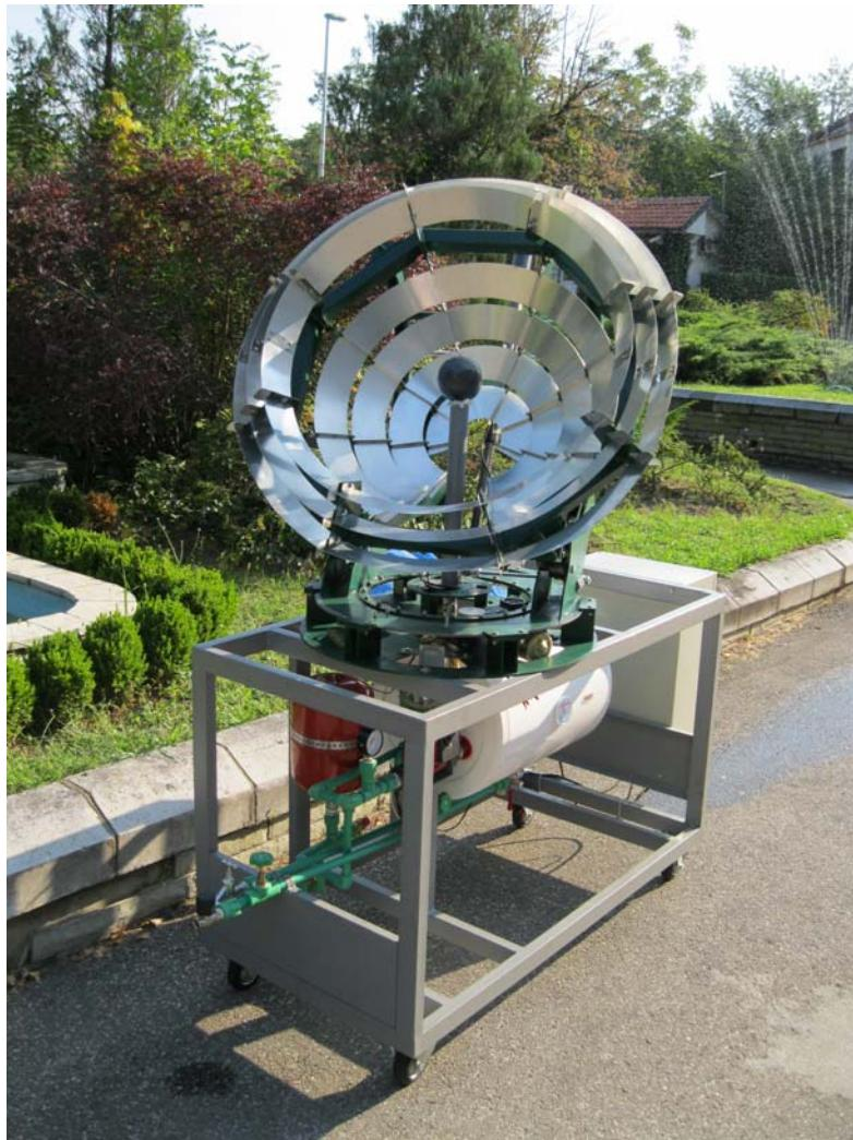
Slika 14: Izgled unapređenog i realizovanog solarnog koncentratora
