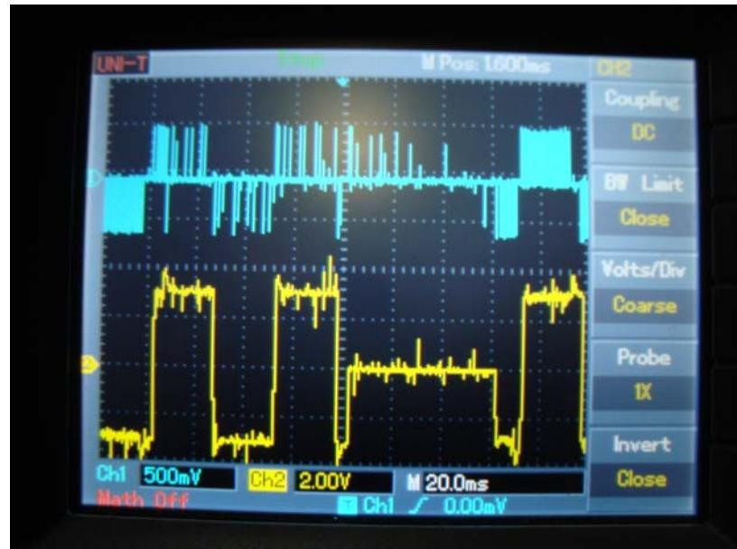
Sl.9. Napon is struja primara VNT u trenutku preskoka; CH1-napon primara VNT (plavi trag)1kV/V, CH2-struja primara VNT (žuti trag) 50A/V, vremenska podela 20ms/c.
