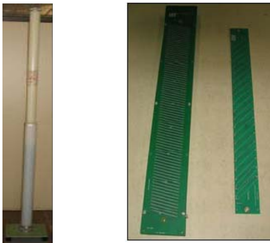
Sl.4. Spoljni izgled samostalnog VN otpornika za merenje napona
