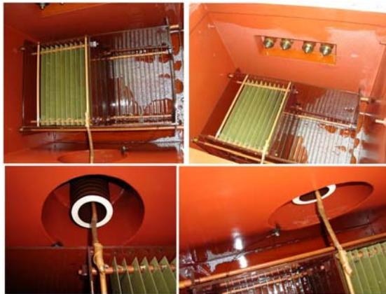
Slika 8: Dispozicije VN otpornika u uljnom tanku (UT), potopljen u transformatorskom ulju korišćenom kao izolacioni medijum ( radni napon  $60\text{kV DC}$ , izlazna snaga  $60\text{kW}$  ).
