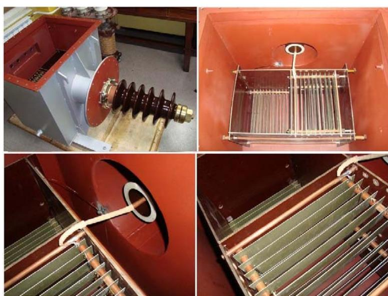
Slika 6: Sud u kome se smešta VN otpornik, sa izolatorom sa VN priključkom (slika gore levo); Izgled VN otpornika u sudu bez ulja (slika gore desno); Detalj povezivanja VN otpornika i VN izolatora (slika dole levo) i dispozicija pertinaks nosećih ploča bifilarno motanog VN otpornika (slika dole desno)
