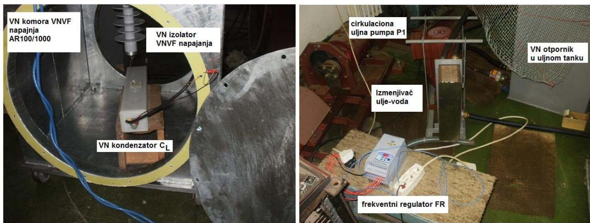
Slika 11: Eksperimentalno postrojenje realizovano u laboratoriji za VN, Minel-ELVO, Beograd; Dispozicija VN kondenzatora CL i njegovo povezivanje sa VN komorom testirane VNPF napojne jedinice AR100/1000 (slika levo); Dispozicija cirkulacione pumpe P1, pripadajućeg frekventnog regulatora FR, izmenjivača topline ("ulje-voda") i uljnog tanka u kojem je smešten VN otpornik 100kΩ/100kVDC/100kW (slika desno)
