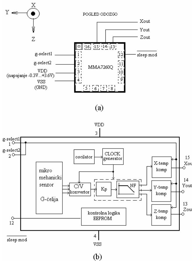
Sl.1-Izgled mernog senzora ubrzanja MM7260Q;(a)-kućište (b)-raspored priključaka
