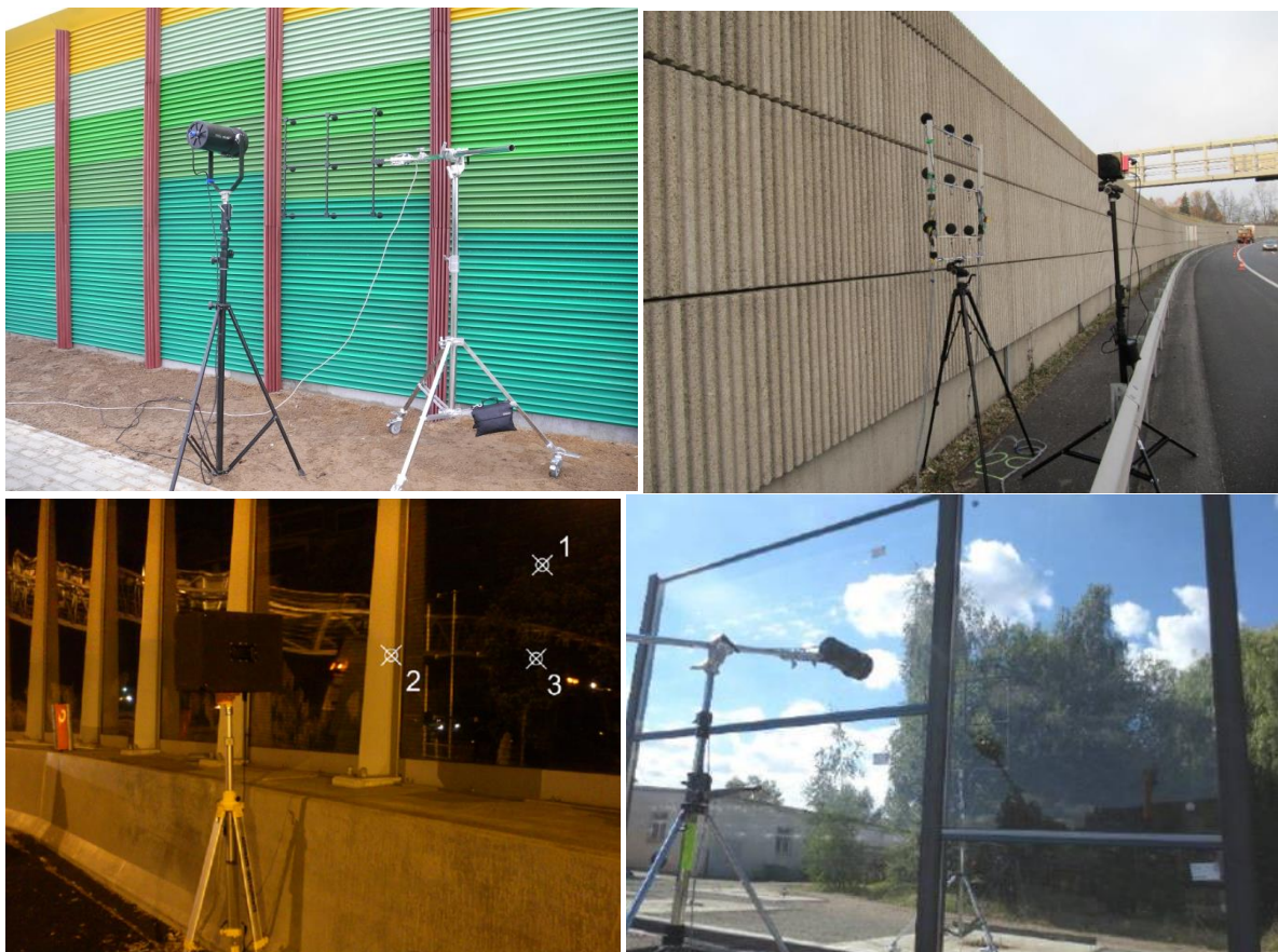
Слика 1 Примери мерења акустичких карактеристика звучних баријера на основу стандарда EN 1793-5 [5] и EN 1793-6 [6]
