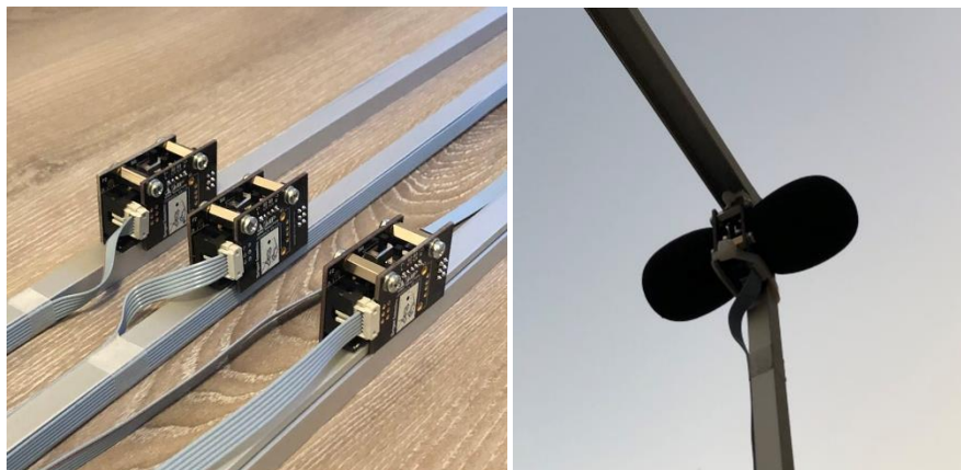
Слика 8 Микрофонски модули монтирани на решетку
