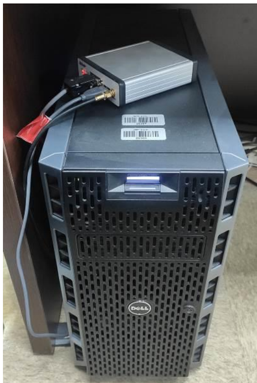
Слика 1 Пример реализације главног Stratum 1 сервера са GNSS пријемником
