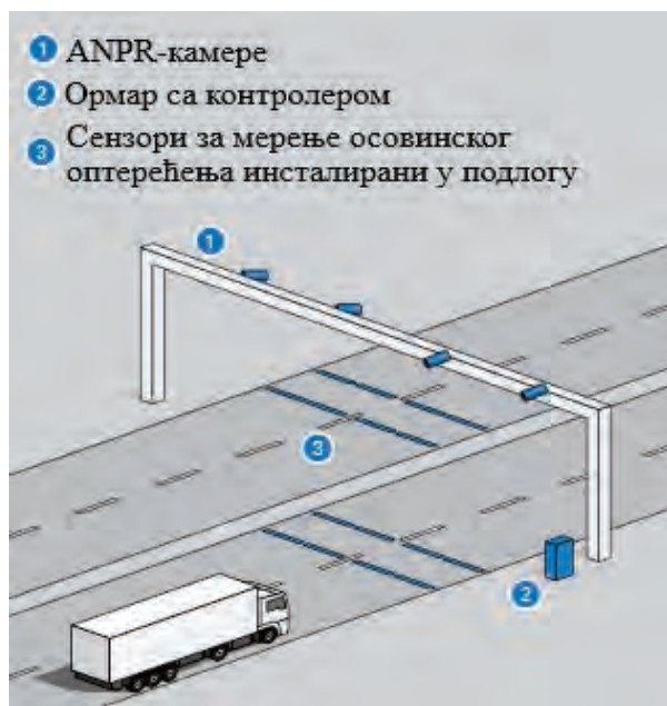
Слика 6. WIM-систем на отвореном путу [6]
