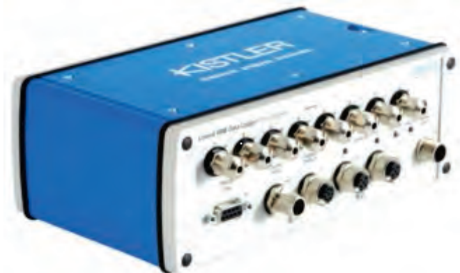
Слика 12. Kistler Data Logger 5204AC08 [6]
