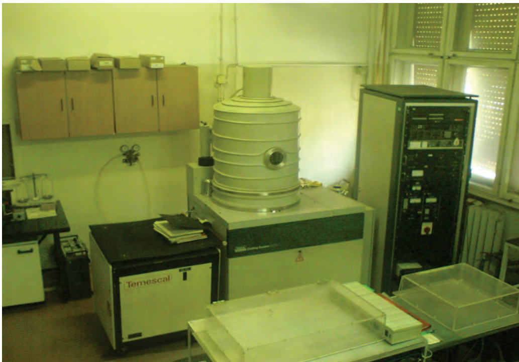
Edwards – високовакуумска пумпа за напаравање
