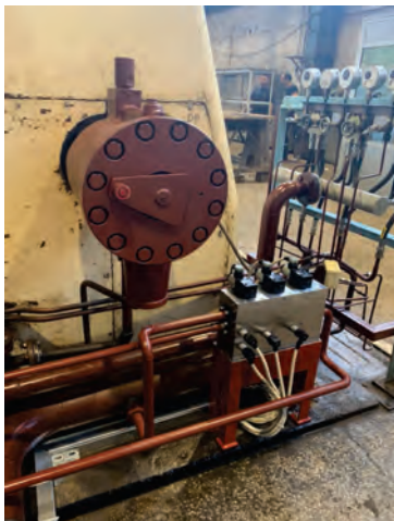
Слика 7 – Примена ТЦимп блока на парној турбини
