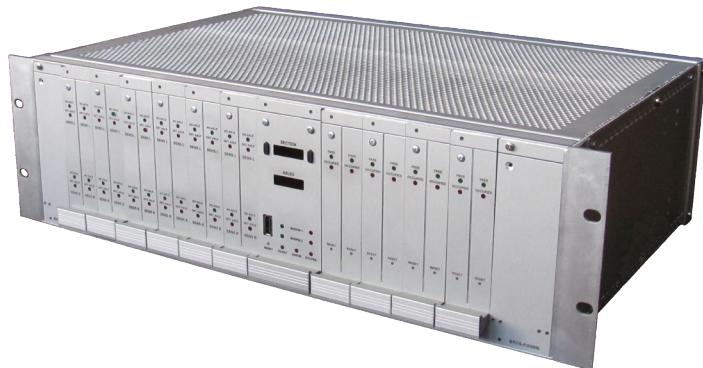
Brojač osovina BROS se koristi za kontrolu zauzetosti pružnih sekcija. Uređaj je instaliran u standardnom reku od 19 inča, visine 3U koji se montira u relejnoj sobi železničke stanice, automatskom pružnom bloku, ili na putnom prelazu u nivou.
